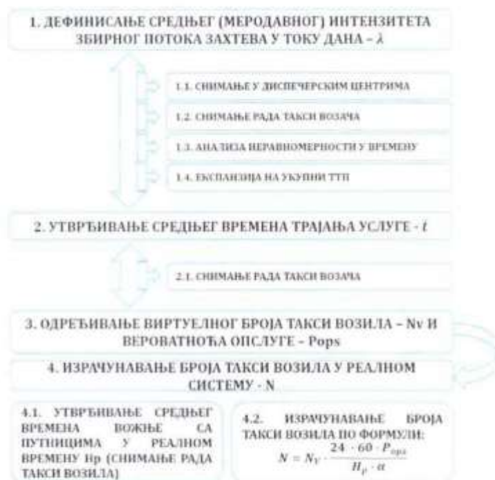
Слика 6.5. Методологија за одређивање оптималног броја такси возила помоћу система масовног опслуживања
